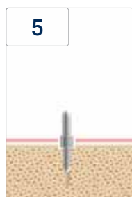
5 Verifica dell'inclinazione con l'indicatore di direzione
